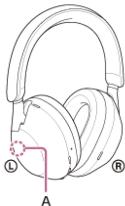
A: Umístění vestavěné antény
